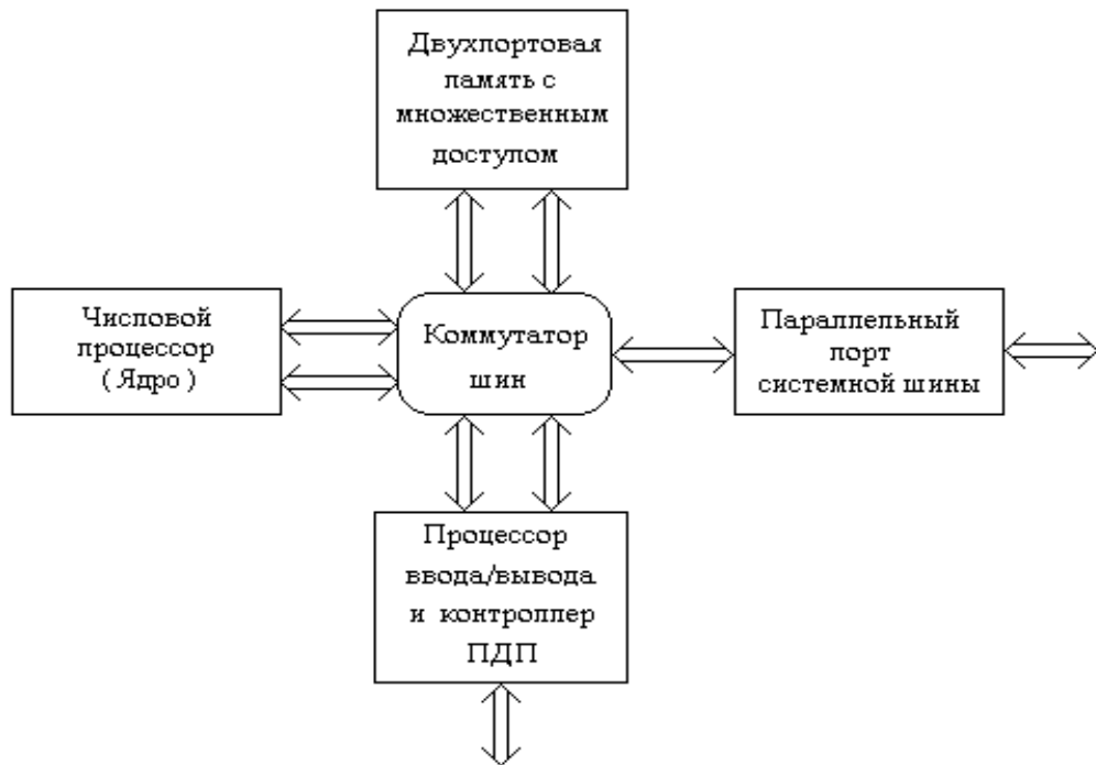
Рис.8.1. Обобщенная структура СБИС семейства ADSP-2106x
